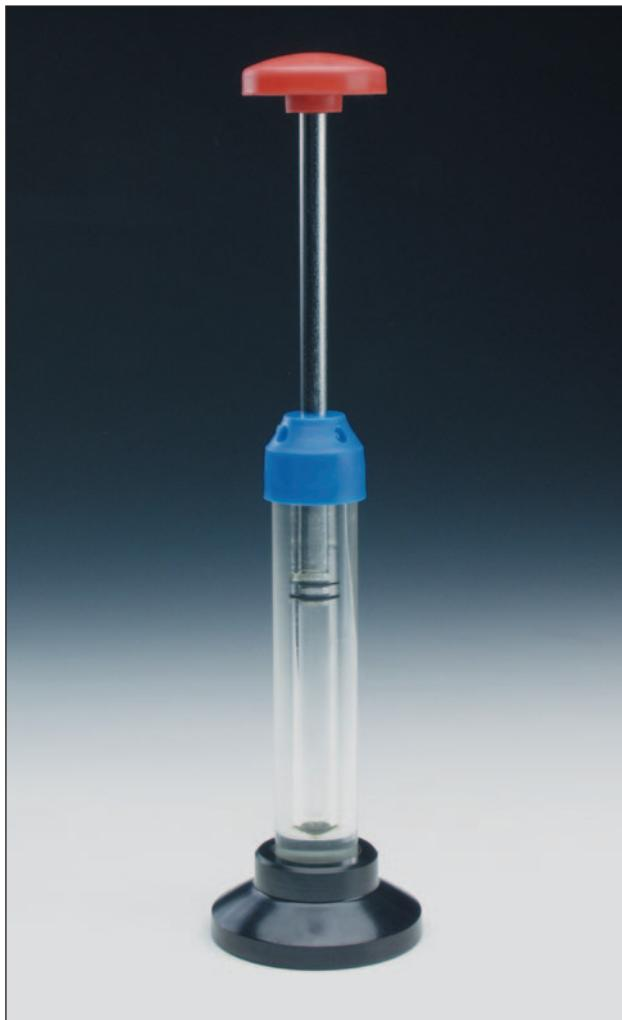
Dette udstyr demonstrerer at en temperaturen for en indespærret gasmængde stiger, når gassen komprimeres. Anbringes et letantændeligt materiale i bunden af den gennemsigtige cylinder, vil dette antændes, når stemplet trykkes i bund med en rask bevægelse. Dette princip anvendes bl.a. i dieselmotorer.
