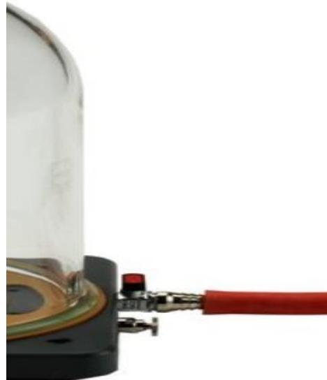
Pumpetallerken tilsluttes en vakuumpumpe (069525) med en slange via en konisk studs med en diameter på 10 mm. Luften i klokken styres med en ventilhane og en fingerskrue for returluft.
