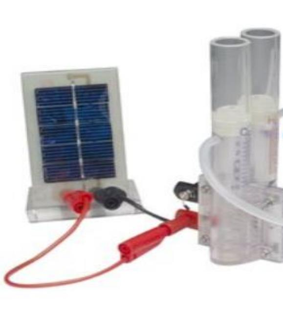
I det sidste trin forbindes solcellepanelet til elektrolysecellen, som vist på billedet. Respekter polariteten: Rød bønsning forbindes med rød, sort med sort. Hvis en anden strømkilde end solcellen (for at accelerere elektrolyseaktiviteten) ønskes anvendt så vær opmærksom på at; inden ledningerne påsættes, sikres at strømstyrken er mindre end 500 mA. Drej omskifteren på belastningsboksen om på *Open Circuit*.
